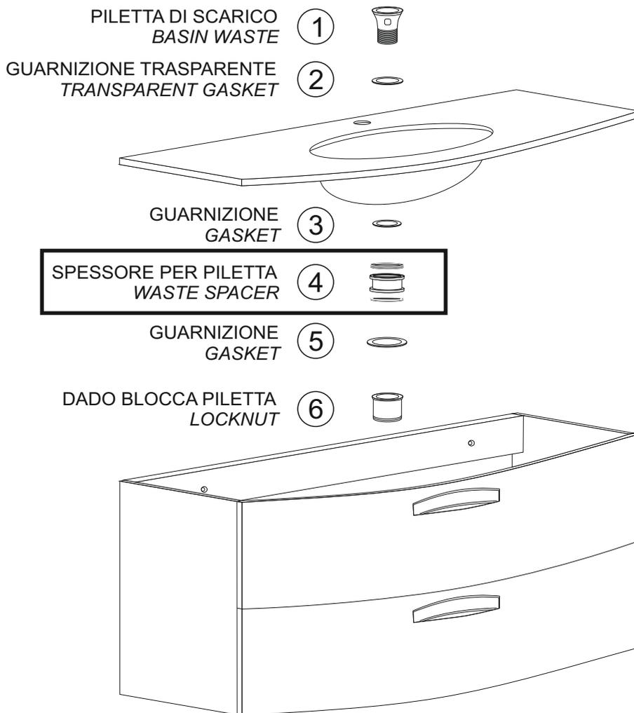
IL COLLEGAMENTO DEL TUBO DI SCARICO DEL LAVABO DEVE ESSERE FATTO DA UN IDRAULICO O DA UNA PERSONA SPECIALIZZATA
