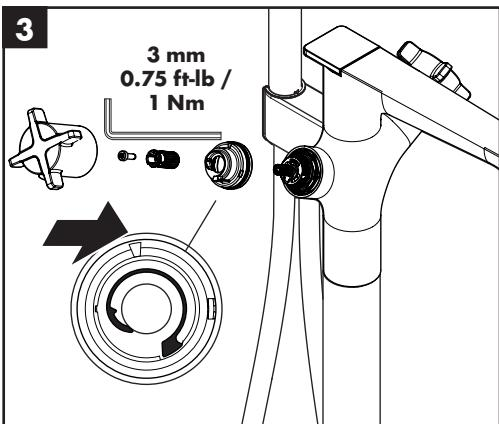
**Set the high temperature limit stop / Réglez la butée limite de l'eau chaude / Fije el tope de límite de alta temperatura\***
