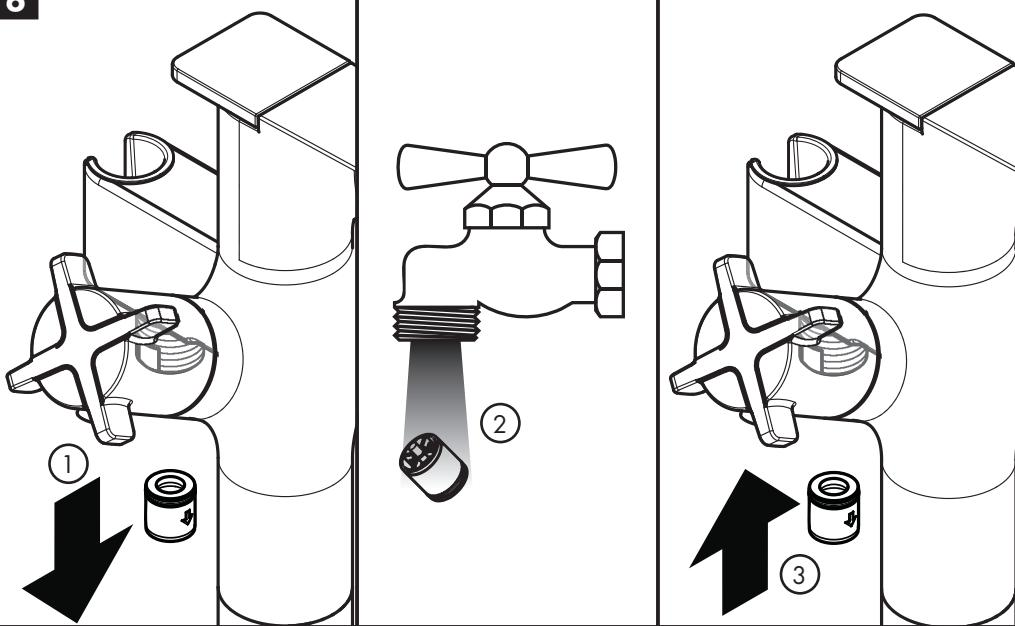
**Reverse the function block / Montez le bloc de fonction à 180° / Girar el bloque de función en 180°**
